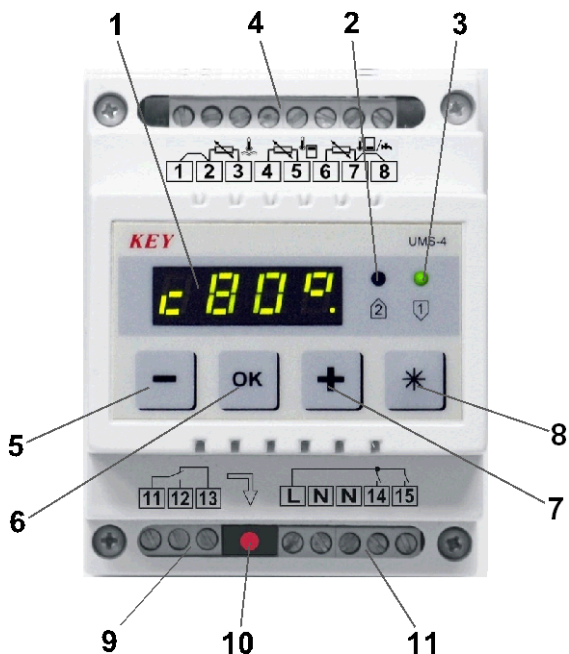
Rysunek 1. Widok płyty czołowej modułu UMS-4A.
